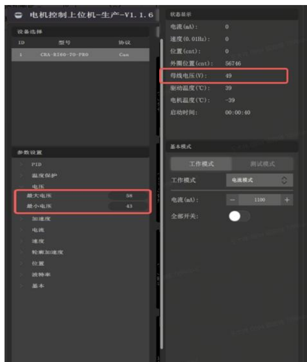
图 3-4 上位机软件设置模组工作电压阈值
