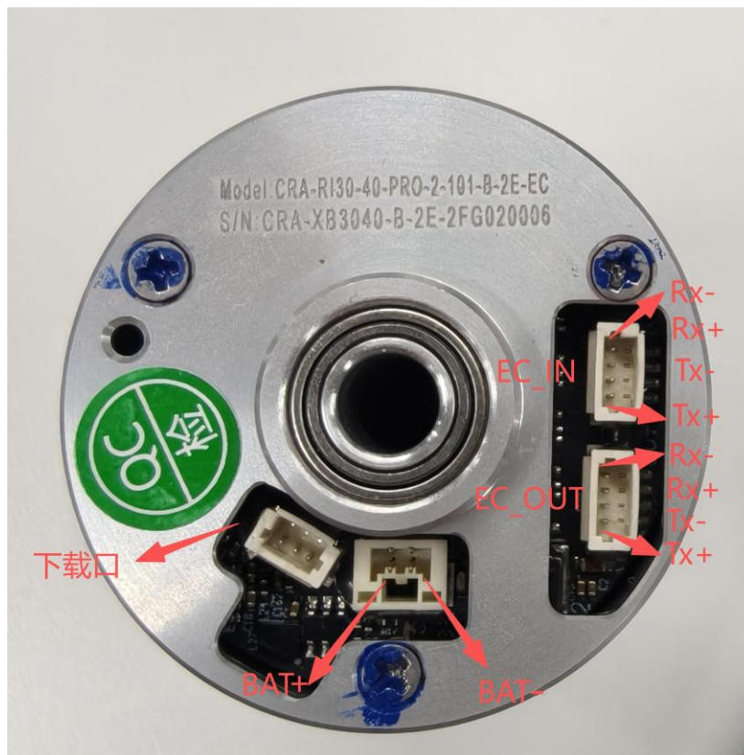
图 4-4 30-40 型号电机只支持 EC 通信接口及端子定义图
